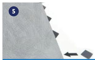
Se insertan las placas metálicas en la ranura de las fundas plásticas.
