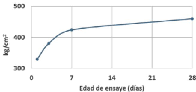
**Resistencia a la flexión ASTM-C-348
