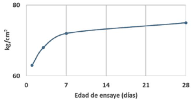
**Nota:** Los datos incluidos fueron obtenidos en condiciones de laboratorio, 24 °C +/- 1 y 50% de humedad relativa. Los datos señalados para tiempo de fraguado y transitable, pueden variar en función de condiciones ambientales y el espesor aplicado.
